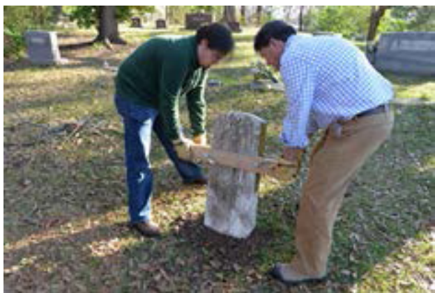
Figura E1. El sencillo sistema de abrazadera de madera permite que dos personas levanten con seguridad una lápida de mármol. Foto: Sarah Jackson.
